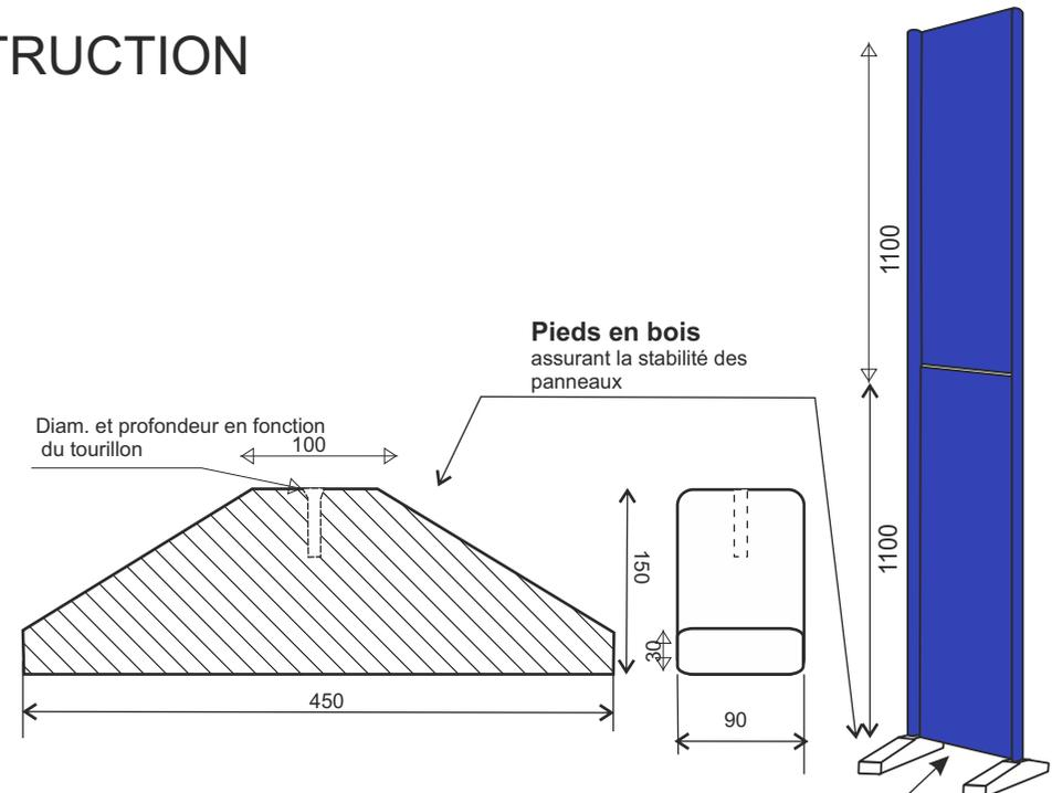
**2 Panneaux bois** servant de supports assemblés par emboîtement sur tourillons métalliques
